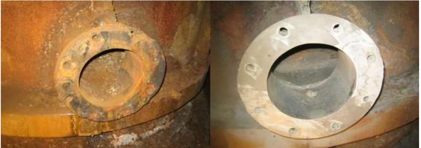
Resimac fabrique une large gamme de produits de réparation métalliques capables de surfaçage des dommages ou des surfaces métalliques usées.
