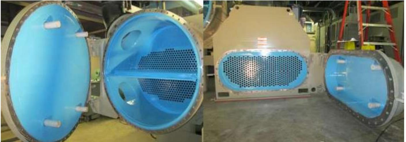
Resimac fabrique une gamme de matériaux résistants à l'abrasion et à l'usure adaptés aux réparations d'équipements soumis à l'érosion et à la corrosion par les fluides.
